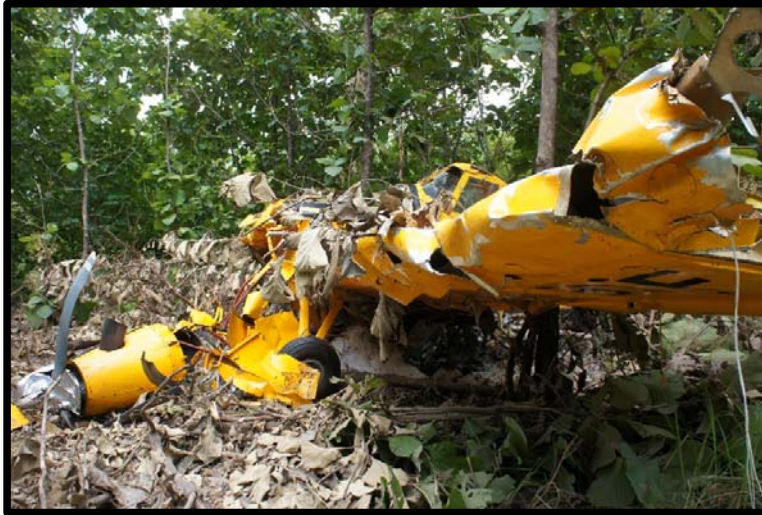
Fotografía No. 3 Motor desprendido del fuselaje de la aeronave debido al impacto a tierra.
