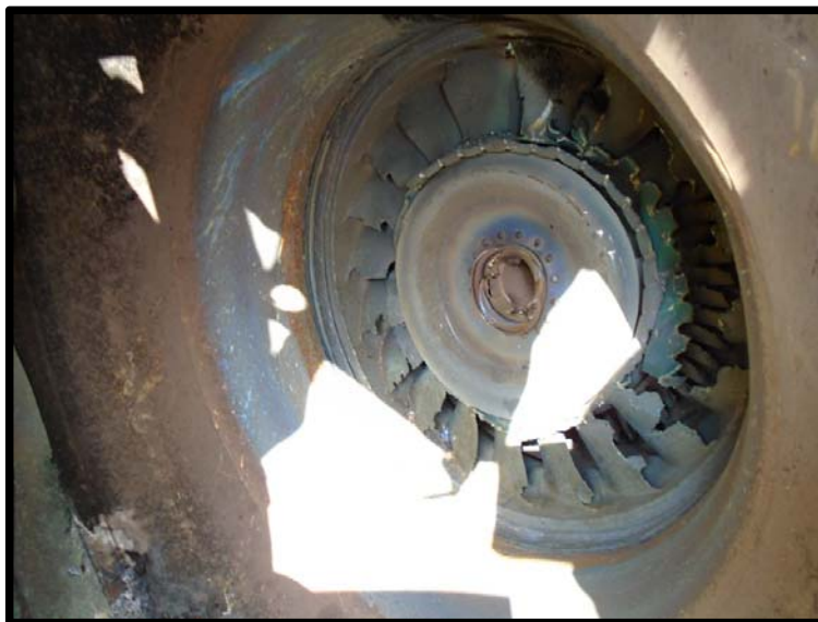
Fotografía No. 14 Daños en la turbina de gases del motor.
