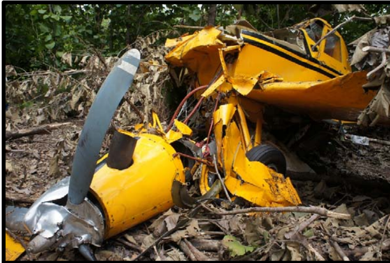
Fotografía No. 5 Daños en el motor, soporte del motor y pared de fuego.
