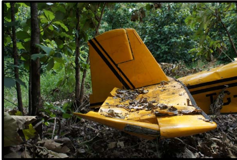
Fotografía No. 9 Vista del estabilizador y elevador derecho dañado.
