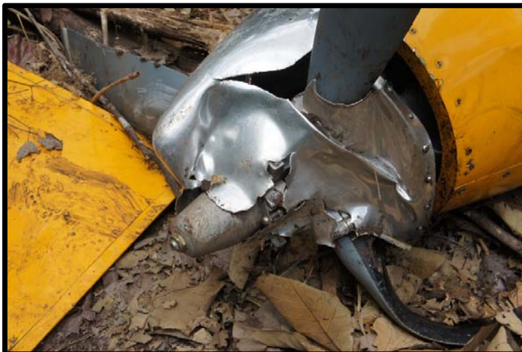
Fotografía No. 6 Daños en el Hub de la hélice debido al impacto a tierra.
