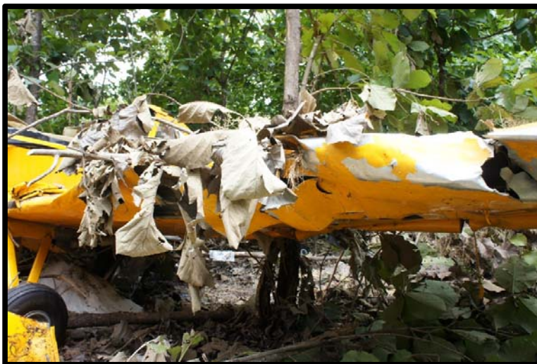
Fotografía No. 4 Daños severos en el ala izquierda.
