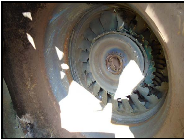
Fotografía No. 14 Daños en la turbina de gases del motor.
