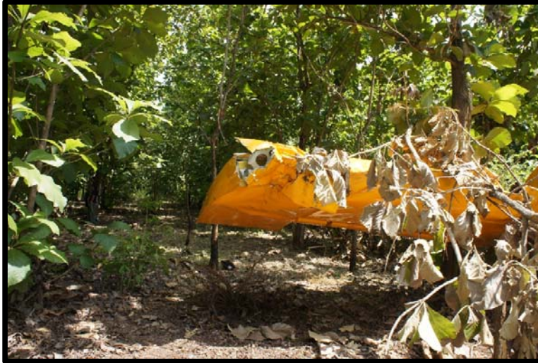
Fotografía No. 7 Punta de ala derecha con golpes al impactar contra los árboles.
